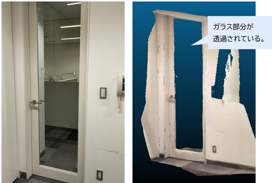
Figure 10 ガラスの点群データを取得しようとした結果
