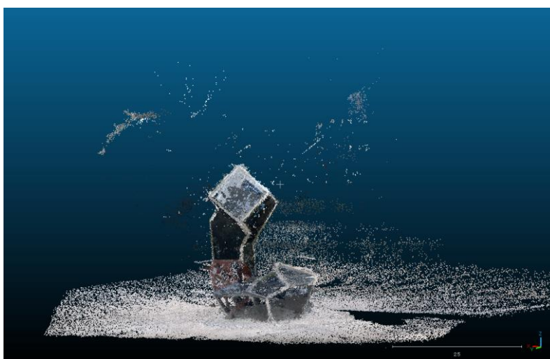
Figure 23 ノイズの発生している点群データ
