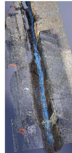
取得した点群データを3Dビューアに表示したり、水道管の深さを計測する等、点群データに対して後処理を実施
