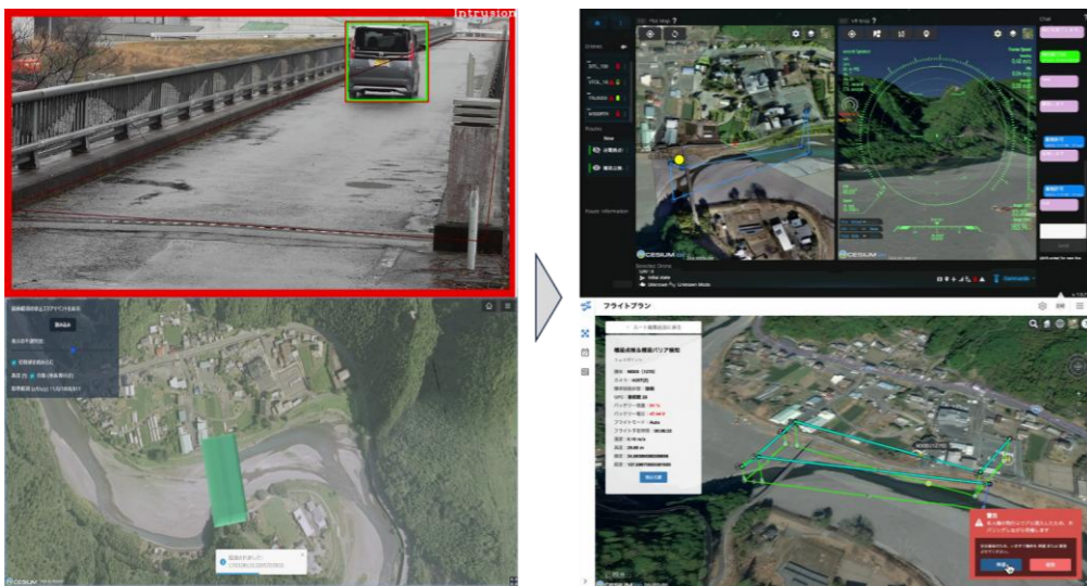
車両が通過している間、橋は自動的にドローンの侵入を不可とする飛行禁止エリアとなる ドローンは飛行禁止エリアが解除されるまで橋の手前でホバリングする
