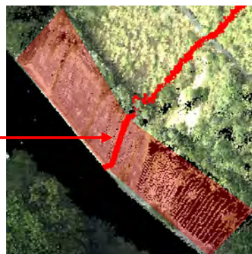
⑤ 推定した法面の候補から連続して 形状が類似する箇所全体を 法面の点群 として抽出
