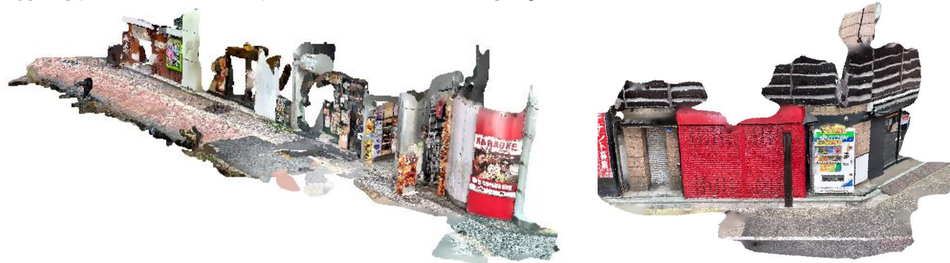
自動重畳が容易な点群の例（特徴点の多い）
